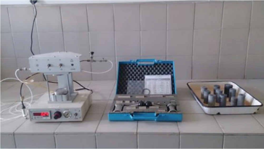
Şekil 5. Helyum porozimetresi cihazı ile referans ağırlıkları ve deneye uygun hale getirilmiş bazaltik kayaç örnekleri (soldan sağa doğru).
